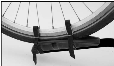
Figure 14 : Sangles de serrage de la roue avant
